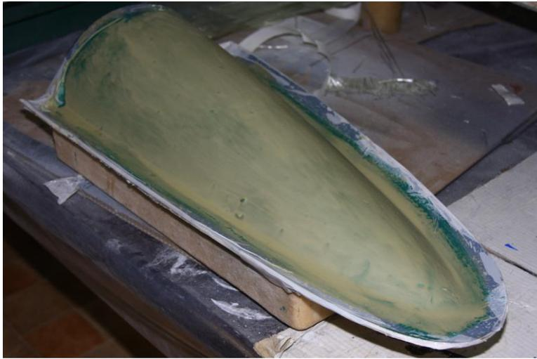
Una vez que ha secado el gel coat Crystic 14 PA o 15 PA a temperatura ambiente podemos aplicar el Barrier coat Crestacoat 5000PA catalizado al 2% con catalizador X-8 (PMEC). El barrier coat debemos dejarlo secar a temperatura ambiente aproximada de 22 °C. Así aseguramos la calidad superficial de nuestro molde evitando las distorsiones provocadas por el “print through” (marcado) de las fibras.
