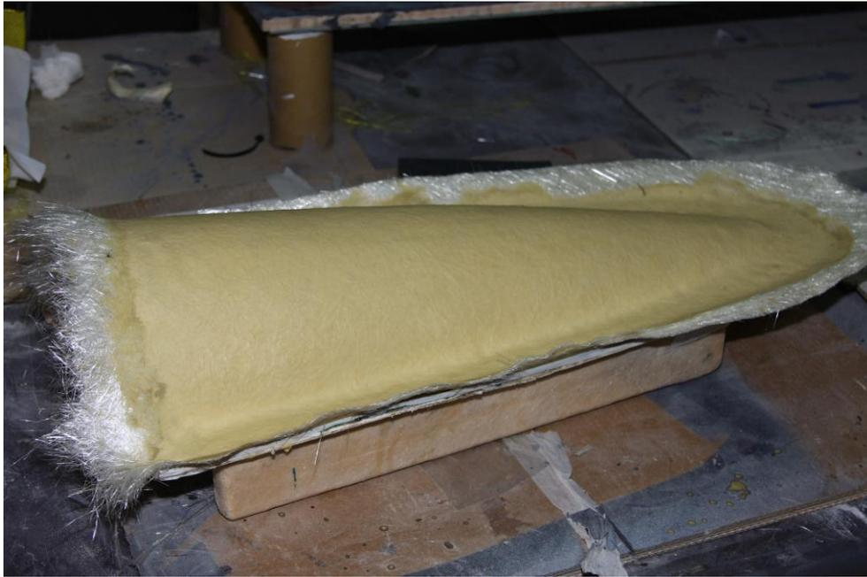
En esta fotografía se observa el cambio de color de la resina Crystic RTR4000PA tras unas horas a temperatura ambiente.
