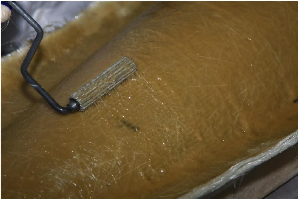
Se pueden aplicar 4 capas de mat 450 en húmedo sobre húmedo para construir un espesor de unos 4 mm de laminado gracias a que la resina Crystic RTR 4000PA dispone de un aditivo que modera la contracción y la exotermia. Además, al tratarse de una resina cargada aporta gran dureza al laminado.
