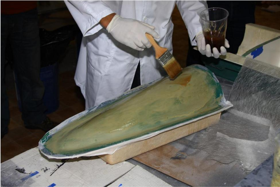
Una vez que ha secado el Barrier Coat, impregnamos la superficie con resina de viniléster-DCPD de baja contracción Crystic VE679PA catalizada al 2% con PMEC (catalizador X-8). Inmediatamente después colocamos un mat de vidrio de hilos cortados de  $150 \text{ g/m}^2$  y lo adaptamos a la superficie hasta que quede totalmente impregnado. También se suele emplear, y es recomendable, un velo de vidrio C de  $30 \text{ g/m}^2$ .
