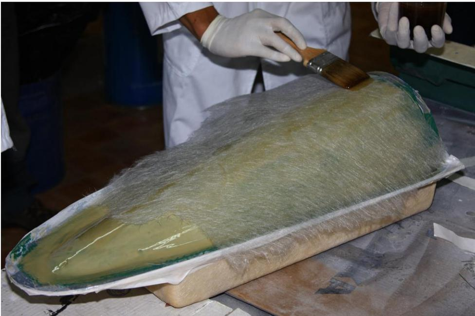
Colocando el mat de hilos cortados de  $150 \text{ g/m}^2$ .
