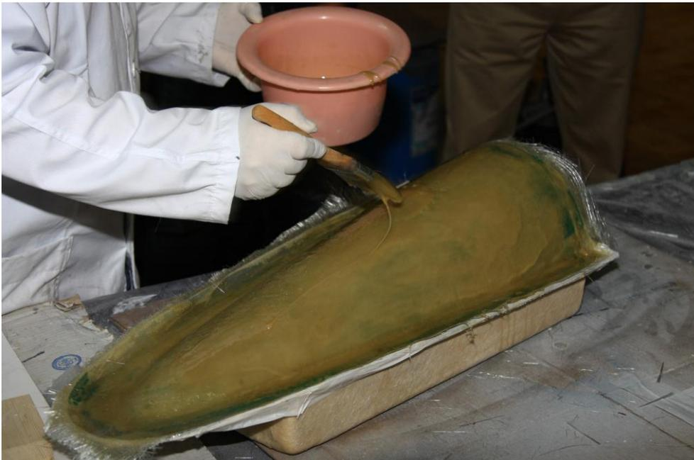
Una vez que el laminado del mat ha secado, impregnamos la superficie con la resina low profile de nula contracción Crystic RTR4000PA. La resina RTR4000PA es una resina cargada de muy especiales características entre las que destaca la nula contracción. Se cataliza al 2% con peróxido de metiletilcetona (catalizador X-8).
