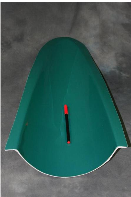
**Molde composite tras el desmoldeo y recorte.**
