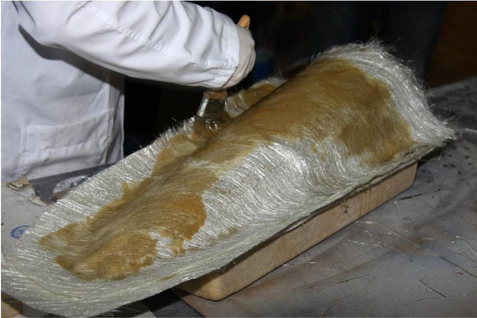
Inmediatamente se aplican mats de hilos cortados de 450 g/m<sup>2</sup> en húmedo sobre húmedo hasta cuatro capas. Entre capa y capa y antes de que polimerice la resina de cada mat se debe pasar rodillo metálico. Como se observa en la siguiente imagen.
